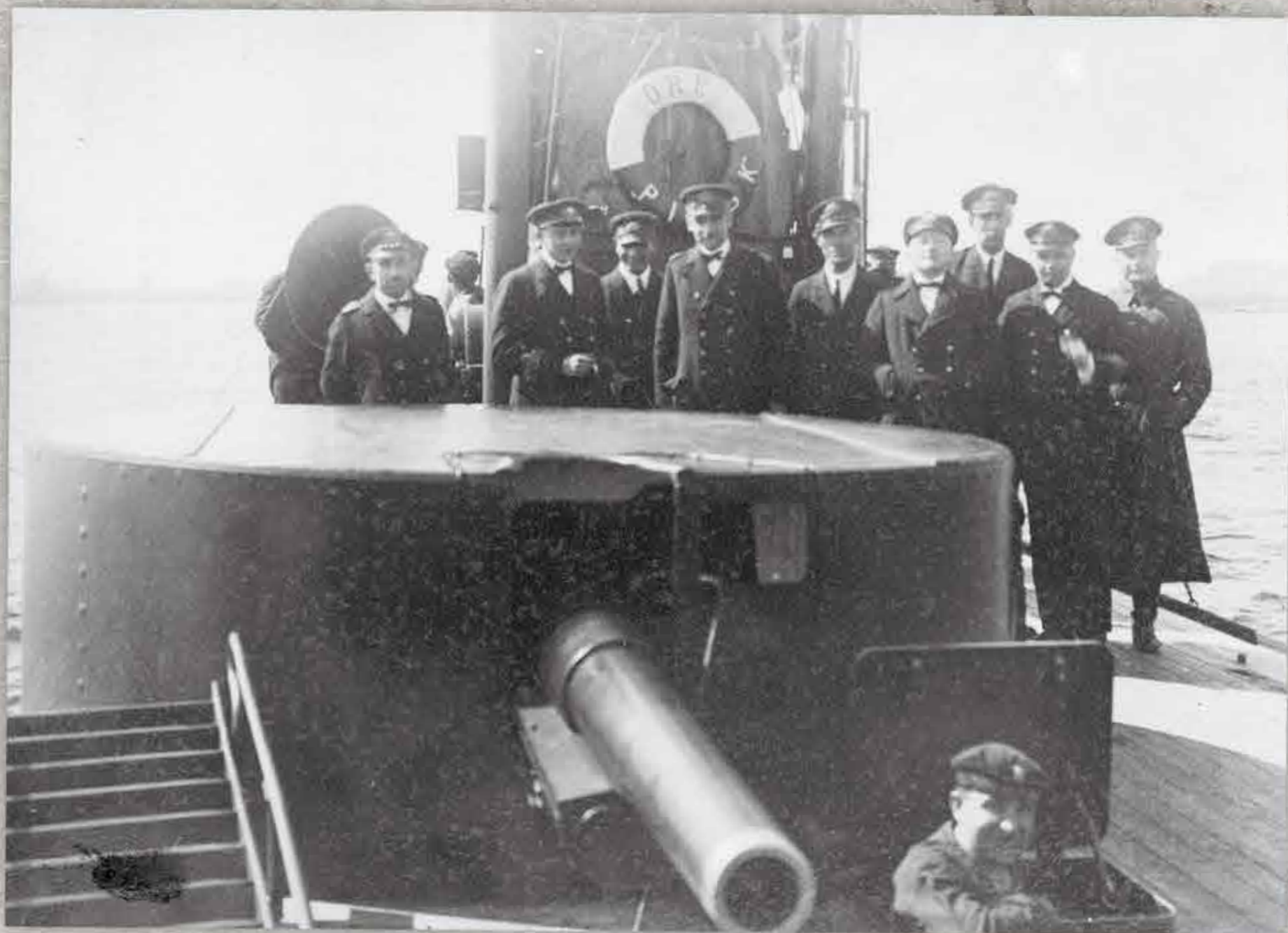
Artyleria główna monitora ORP „Pińsk” przed zmianą w 1930 r., francuska armata systemu Schneider wz. 1913 kalibru 105 mm. Ze zbiorów Muzeum Marynarki Wojennej w Gdyni.
